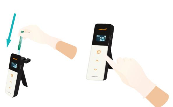
ルシパックA3 Surfaceをルミテスターの測定室に入れ、ルミテスターを立てて測定します。
