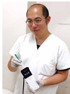
写真2 ATP検査(A3法)の最大の特徴は簡便性と迅速性。ふき取った綿棒を測定装置にセットすれば、10秒程度で清浄度(汚染度)が数値で評価できる
