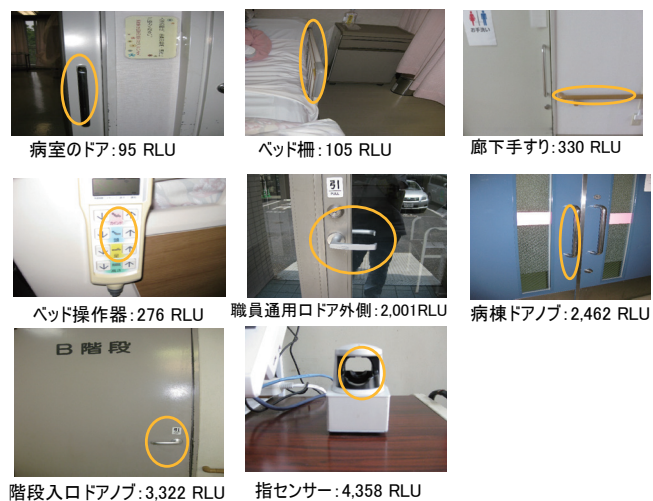
写真4 慢性期病院におけるATP検査の例 ①
