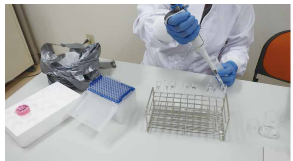
検体の前処理とピペット操作だけで、簡便かつ迅速に高精度なヒスタミン測定ができる。
