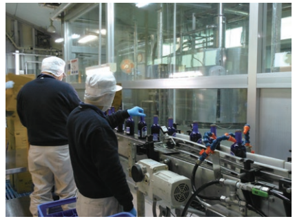
瓶の充てんラインでは、手作業で空き瓶を並べ（左写真）、水で洗浄する（中写真）。充てん後、「ラベルの状態は適切か」「賞味期限の誤りがないか」「王冠がきちんとはまっているか」などを全数目視でチェック（右写真）
