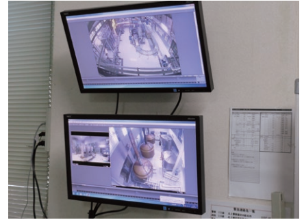
工場内をモニタリングするためのカメラを設置 (左写真)。カメラの映像は、工場外のモニターで確認できる (右写真)
