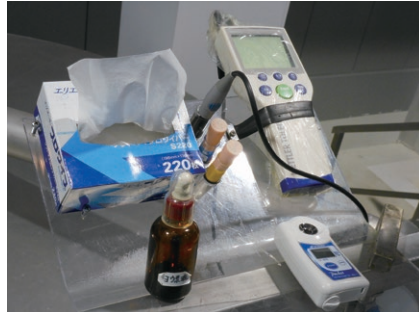
糖化釜、煮沸釜、ろ過釜は、工場の竣工時にドイツから購入して以来、丁寧に使い続けている（左写真）。仕込み工程で排出された麦芽粕やホップ粕は地元の畜産農家へ肥料の原料として提供されている。糖化の過程の pH や糖度などは詳細にチェックし、記録に残す（中写真）。昔ながらの糖度計も現役で活躍中（右写真）
