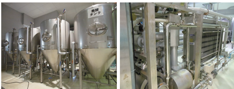
糖化→ろ過→煮沸を経て、酵母を投入し、タンク内で醗酵させる（左写真） 醗酵後、加熱処理を行うフラッシュバストライザー（74℃で5分保持）。温度記録は制御盤の表示温度を確認し、記録しておく（右写真）
