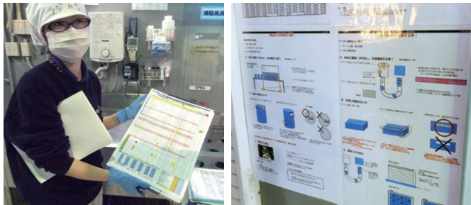
日々の作業の内容や記録を1枚に集約したシートを開発。要注意箇所を黄色く塗るなど、随所に工夫が施されている（左写真） イラスト入りのわかりやすい作業手順書を掲示（右写真）
