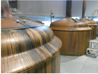
糖化釜、煮沸釜、ろ過釜は、工場の竣工時にドイツから購入して以来、丁寧に使い続けている（左写真）。仕込み工程で排出された麦芽粕やホップ粕は地元の畜産農家へ肥料の原料として提供されている。糖化の過程の pH や糖度などは詳細にチェックし、記録に残す（中写真）。昔ながらの糖度計も現役で活躍中（右写真）
