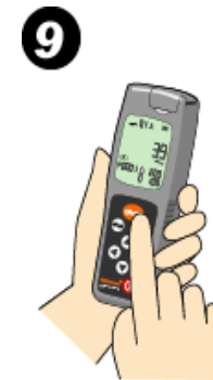
測定器は立って状態で 測定する
