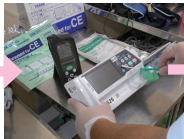
②検査対象を ATP 検査の専用綿棒でふき取る。
