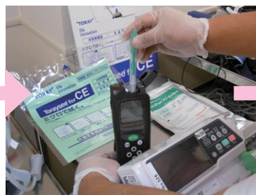
⑤試薬を測定装置「ルミテスター」にセット。
