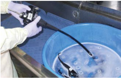
用手洗浄を始める前に、スコープを水中に浸して気泡が発生しないか、漏水テストを実施。
