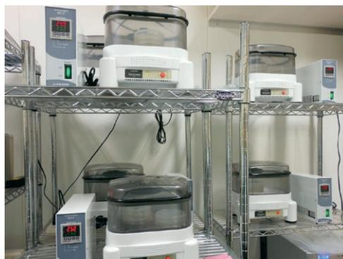
4 台のバイオブローラを設置。培養を行うことなく、微生物を迅速、高精度、かつ容易に測定できる
