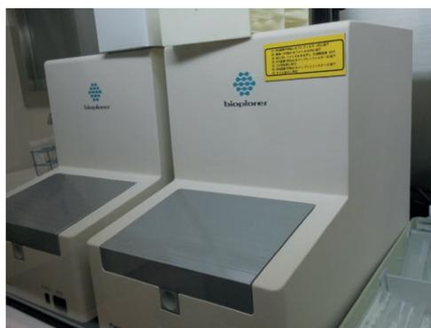
微生物検査のために多数のインキュベーターを設置。さまざまな温度での培養を同時並行で行える
