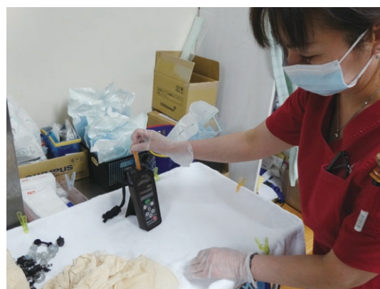
写真6 ATP+AMP ふき取り検査では、綿棒を装置にセットすれば、10秒程度で結果が数値化される
