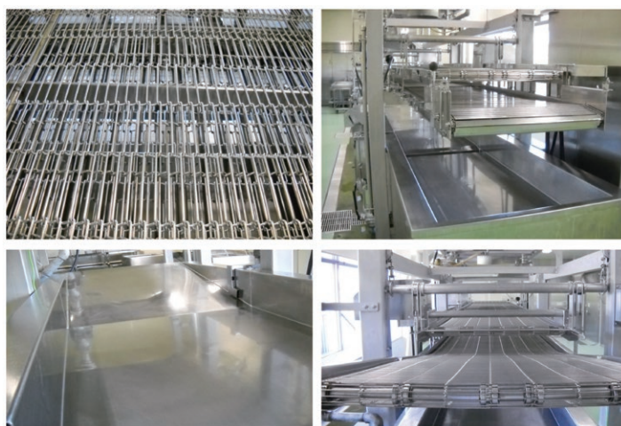
写真2 ATP検査とフォーム洗浄によって高い清浄度を維持している豊橋市北部学校給食共同調理場（担当校は小学校13校および中学校6校、生産規模は約1万食）
