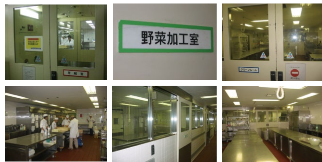
写真2 工程ごとに作業室を区画。清浄度は清潔区・準清潔区・汚染区の3段階に分け、どの区域かは入口扉のプレートの色で一目瞭然
