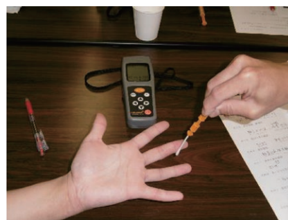
写真3-2 研修での実習例2 ATP 検査を活用した手洗い実習の様子（基準値は合格＝1500RLU 以下、許容範囲＝3000RLU 以下に設定）
