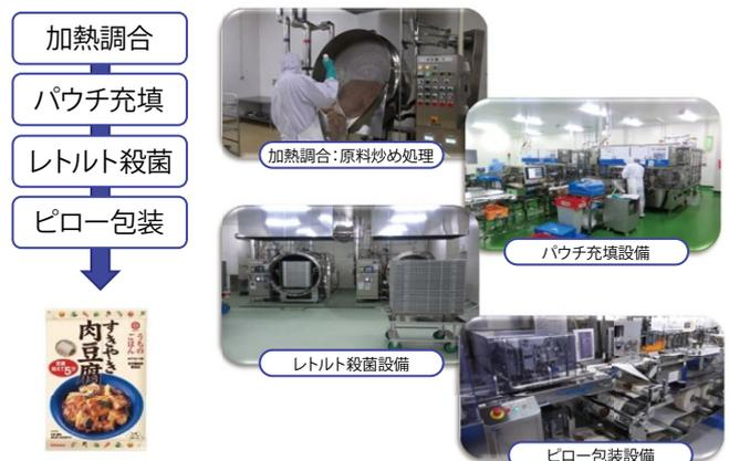
図1 レトルト製品の製造フローの概要
