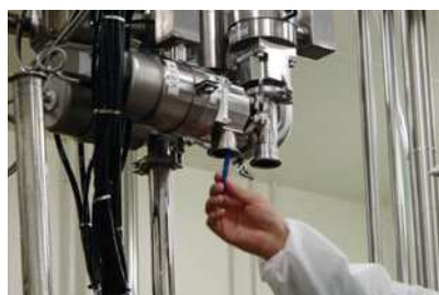
写真4 ATPふき取り検査の活用例1 製造ラインの使用前とCIP後は必ず清浄度を確認 (洗いにくい箇所、見にくい箇所などをふき取る)
