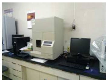
写真5 汚染源調査のための検査体制も整備されている(左:DNAシーケンサー、右: MALDI-TOF/MS biotyper)
