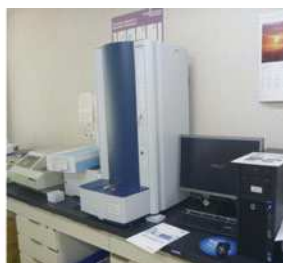
写真5 汚染源調査のための検査体制も整備されている(左:DNAシーケンサー、右: MALDI-TOF/MS biotyper)
