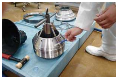
写真5 ATPふき取り検査の活用例2 分解して手で洗浄する箇所などをふき取る
