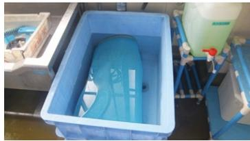
飯取り作業後のメッシュベルト（左写真：製造中、中写真：洗浄後）。ベルトは分解して除菌洗浄後、1時間の塩素消毒をルールとしている（右写真では折りたたんだメッシュベルトを籠に沈めて消毒している）
