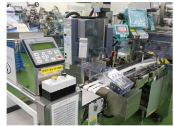
ラベル貼付、計量などを経て、金属探知機を通す。金属検出工程は CCP として設定
