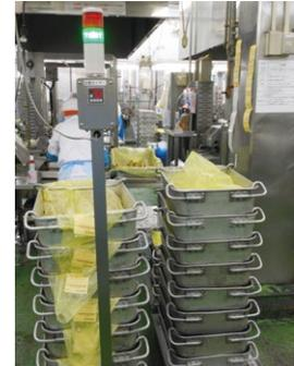
写真1 現場による改善事例①手をかざすとアルコールが噴霧される機構。現場が考案し、工務部門を中心に自作した。アルコールボトルを介した二次汚染を排除するための工夫（実用新案取得）。写真は具材をカットする切り込み工程
