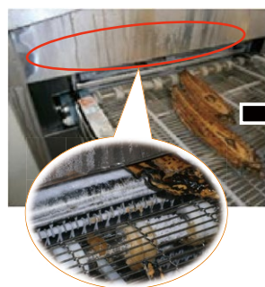
写真3 結露水の製品への落下防止の取り組み事例
