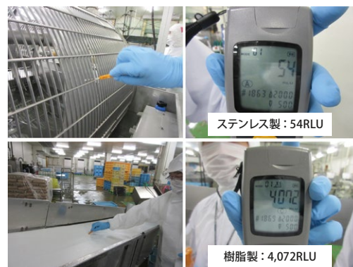
写真8 作業前・使用前に設備のATP検査を実施
