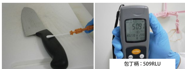
写真15 包丁は柄の部分が衛生管理の盲点になりやすい。汚れが落ちにくい材質（木製など）や構造（凹凸が多いなど）の場合は特に注意が必要
