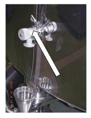
写真 3 (左) 調合タンクでは、サンプリン グコックの配管内面を 2 周ふき取る
