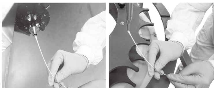
写真2 長軸綿棒がついた ATP 検査試薬「ルシパックLS」の使用例 （写真提供：キッコーマンバイオケミファ（株）、製品紹介用写真より）
