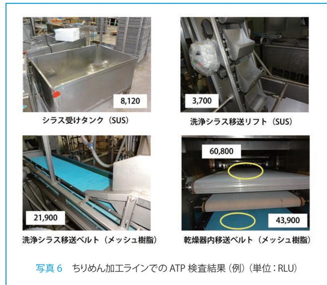
写真6 ちりめん加工ラインでのATP検査結果 (例) (単位: RLU)
