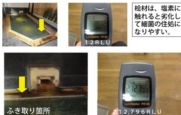
写真3 桧浴槽の汚染調査の事例
