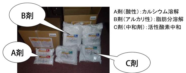
写真5 PC工法で用いる3種類の薬剤。
