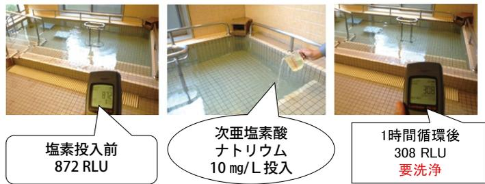
写真2 高濃度塩素消毒の効果を ATP 検査（水中法）で検証
