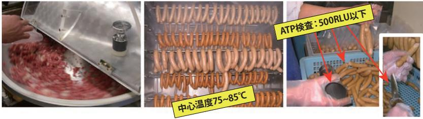
写真2 「ソーセージ工場のOPRPの事例:加熱殺菌後のパック工程で使うハサミやサンテナなどでATP検査
