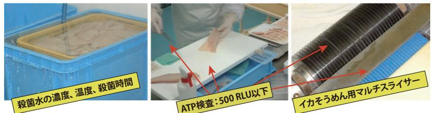
写真7 イカそうめん工場のOPRPの事例：まな板やナイフ、スライサーの刃などでATP検査
