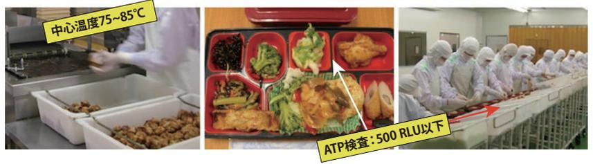
写真5 弁当工場のOPRPの事例：再利用する容器の内側などでATP検査
