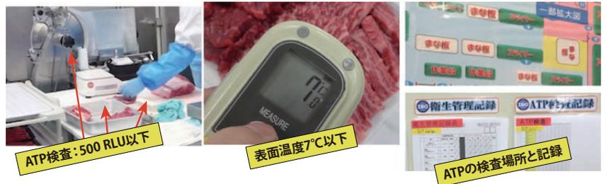
写真6 精肉工場のOPRPの事例：スライサーの刃などでATP検査
