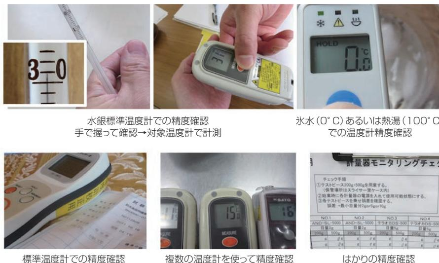
写真9 検査機器の検証方法 (例)
