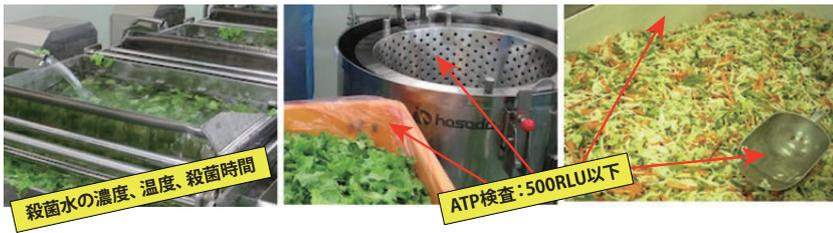
写真3 カット野菜工場のOPRPの事例:脱水槽の内側、パック工程で使用する容器やスコップなどでATP検査
