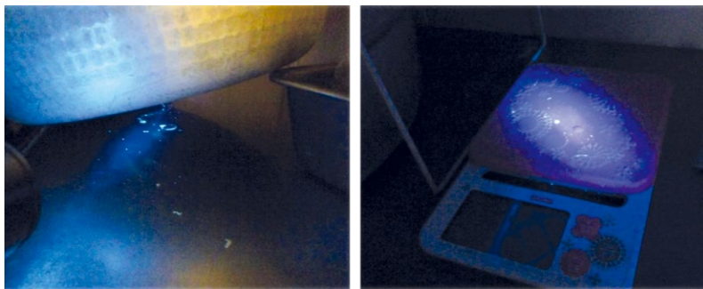
写真7 シンクの汚れが調理台（鍋底が接している箇所）を二次汚染している状態が見られた（左写真）。調理台上のスケールにも汚れが見られた（右写真）
