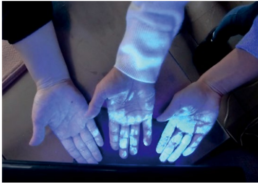
写真1 ビタミン B2 を「汚れ」に見立てて「二次汚染の見える化」(蛍光検査)を体験(写真では青白く光って見えるが、実際には蛍光黄色)
