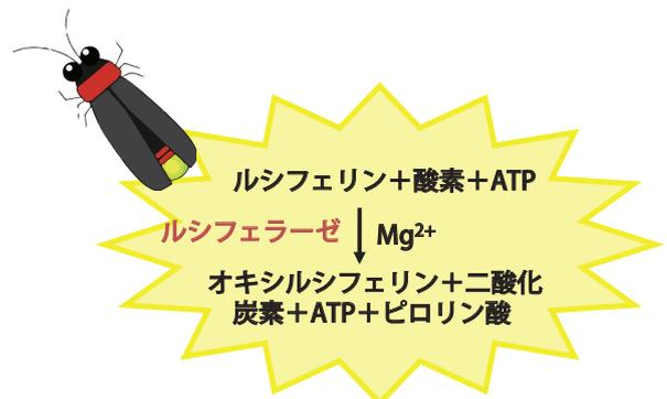
図2 ATPの超高感度測定の原理
