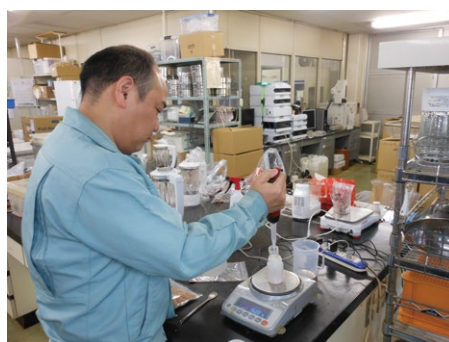
②検体 1g に抽出溶液 24ml を加えて攪拌し、沸騰水で 20 分加熱。その後、冷却する。
