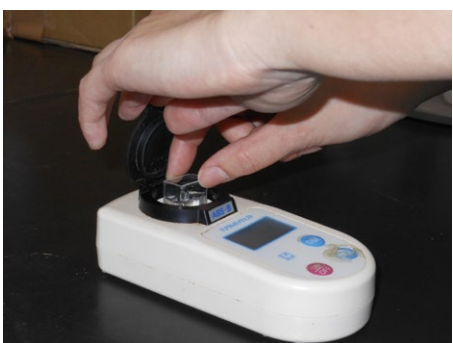
⑤各チューブの反応液の吸光度 (470nm) を測定し、計算式に当てはめてヒスタミン濃度を算出する。
